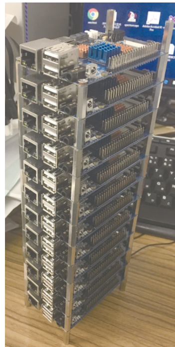
図3 : Banana Pi 12個をつなげている様子。もう一列にはBanana Pi 11個+Raspberry Pi 1個をつなげる。これら2列, 計24個でPIsを構成する。
